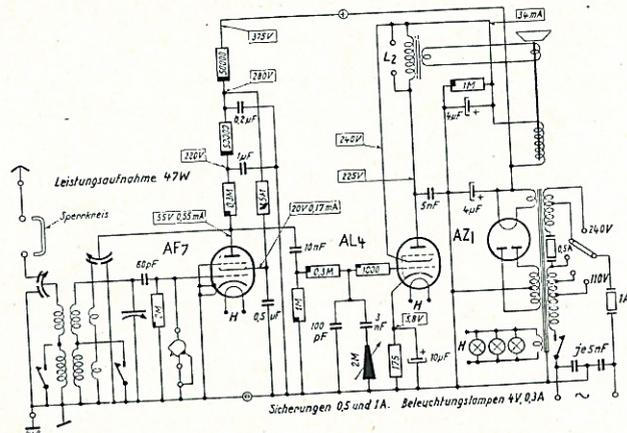
Abb. 135. Schaltbild des „Emud-Record 31W“ für Wechselstrom, Kenn-Nr. 5
